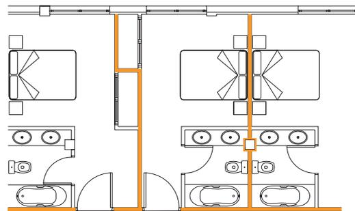
**Obra de fábrica sin bandas elásticas, trasdosado de entramado autoportante a una cara. (Tipo 1 s/DB-HR)**
