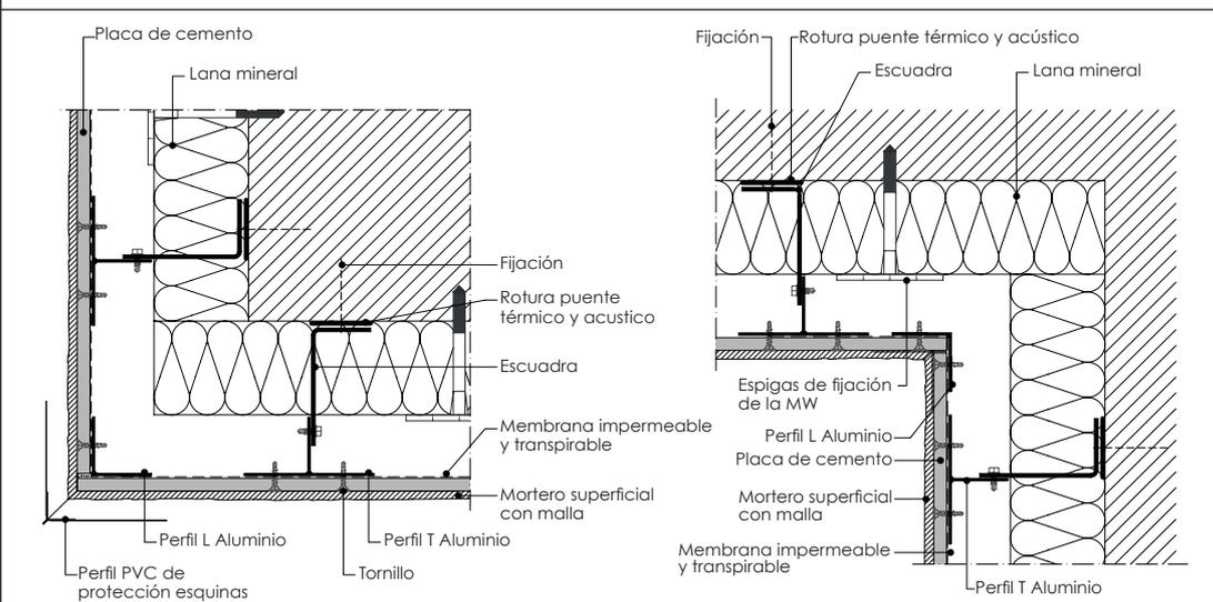
**K.10.4. Solución junta de dilatación edificio**
