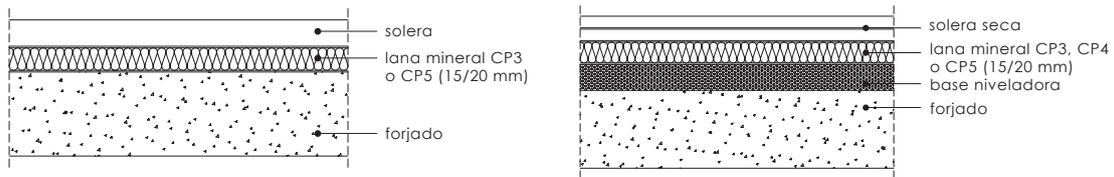
Un aspecto importante es el encuentro de otros elementos de la obra con los "suelos flotantes". Los elementos rígidos del "pavimento flotante" no deben estar nunca en contacto directo con otros elementos rígidos verticales. La unión siempre se realizará a través de elementos elásticos, como la propia lana mineral, tal como se indica en los esquemas adjuntos y que mas adelante son representados de manera más general:
