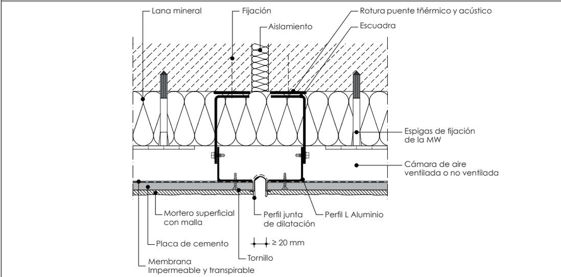
**K.10.5. Sección vertical fachada ventilada o no ventilada**
