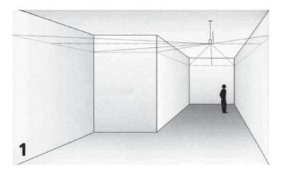
• Una vez marcado y asegurándose que está al nivel pretendido, se fijará el angular de borde al paramento, afianzándolo con tornillos o clavos.
