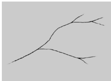
Figura 46 Ejemplo de fisuras ramificadas
