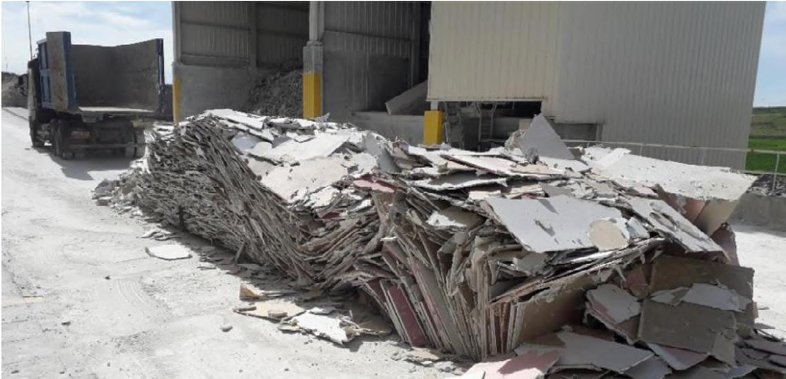
*Figura 36. Descarga de residuos de yeso para su posterior reciclaje en el centro de un fabricante de PYL.*
